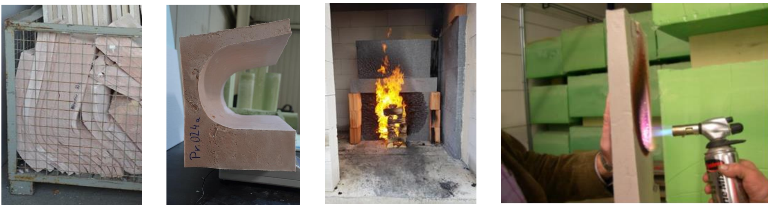
Verformungen im Langzeittest, Baumuster Rollladenkasten, Brandtest (v.l.n.r.)
